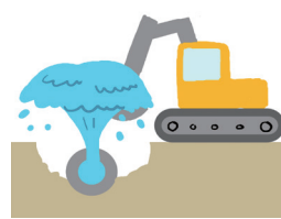
ユーザーが舗装工事中バックホーの操作を誤り、水道管を破損させた。
