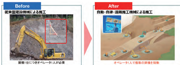
図-6 従来施工から自動化・遠隔化へ
