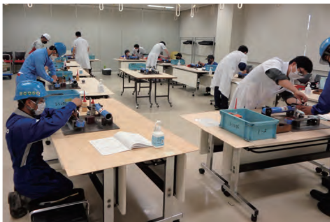
③建設機械整備 実技講習会（油圧シリンダの分解組立）
