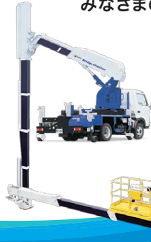
AT-170TG 最大地上高：17.2m 最大作業半径：15.9m バスケット積載荷重：200kgまたは2名
