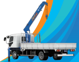
ZX364 最大地上揚程：約11.4m 最大作業半径：9.8m つり上げ荷重：2,930kg
