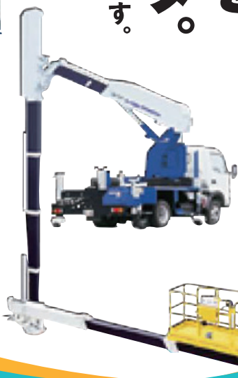
BT-200 最大地下深さ：5.4m 最大地上高：7.0m 最大作業半径：5.1m デッキ積載荷重：200kg
