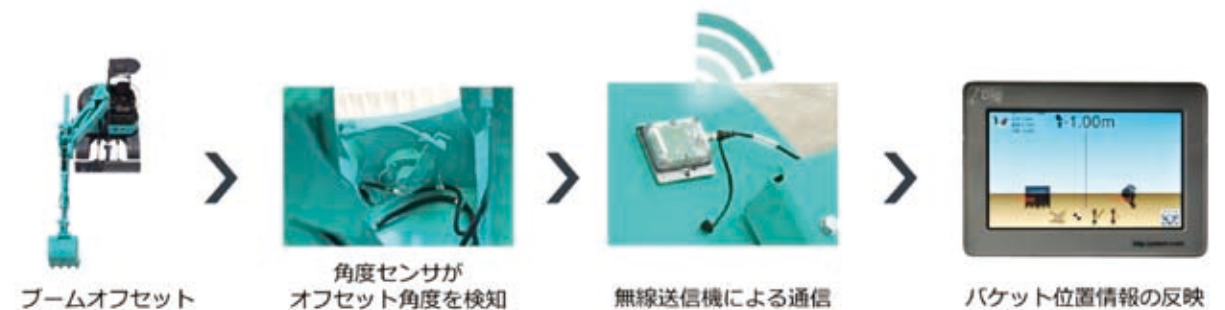
図3 オフセット角度の検知方法
