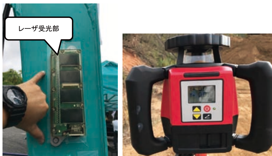
図5 iDig Dozer用アームセンサと回転レーザー
