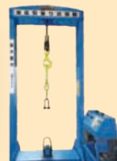
■9t 油圧引張り試験機
