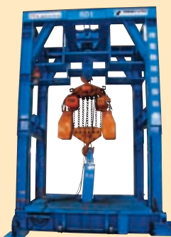
■50t 揚重機械試験装置
