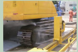
人手の掛からない自動洗浄ロボットにより重機
