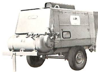
DPV-175S 5.0m 3 /min・7kg/cm 2 ・ヘーンロータリー形 いすゞ DA-220・53PS/2000rpm
