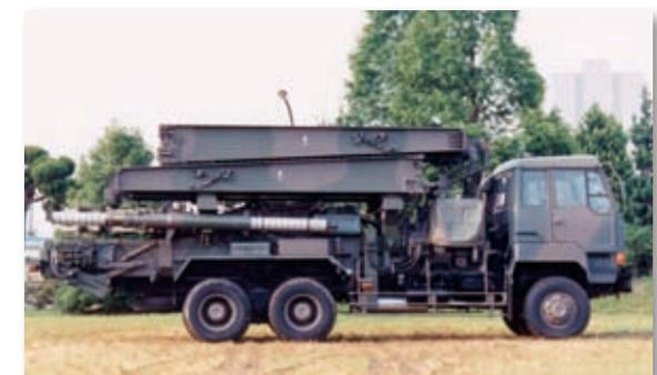
写真-10 81式自走架柱橋
