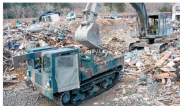
写真-5 瓦礫を運搬する資材運搬車
