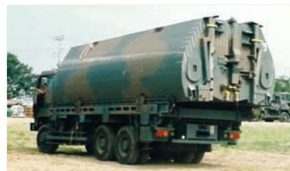
写真-8 92式浮橋の橋節運搬車
