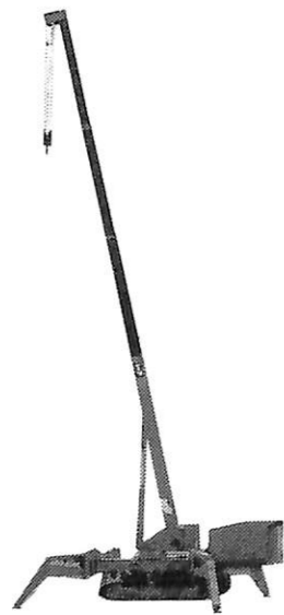
ミニクレーン ゴムクローラークレーン TC304(3ton) TC205(2ton)
