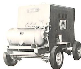
DPV-175S 5.0m 3 /min・7kg/cm 2 ・ベーンロータリー形 いすゞDA-220・53PS/2000rpm
