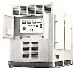
DCA-55SS 45/50kVA・200/220V・50/60Hz いすゞDA120・76.5PS/1800rpm
