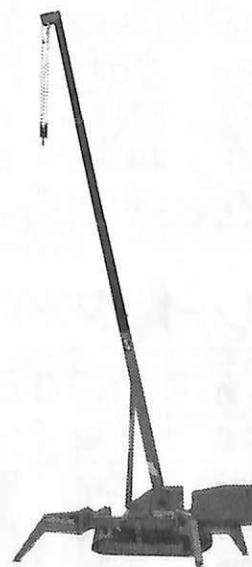
ミニクレーン ゴムクローラークレーン TC304(3ton) TC205(2ton)
