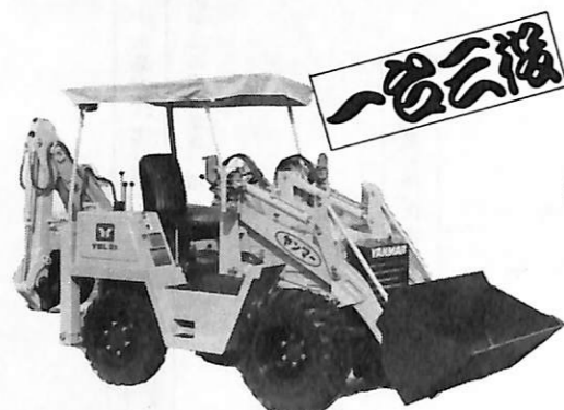
ヤンマーホイールバックホーローダ YBL21 ●エンジン出力:20馬力 ●バックホー・バケット容量:0.06m 3 ●ローダ・バケット容量:0.30m 3
